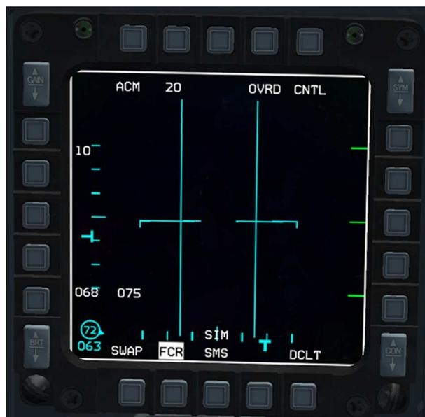
Le mode ACM a remplacé le mode CRM en dessous de l'OSB 1, en haut à gauche de l'écran. Notez que l'échelle de distance est réglée par défaut à 10 NM. C'est la distance maximale à laquelle le mode ACM vous permettra d'accrocher une cible, ce qui est logique pour un mode d'accrochage à vue.
