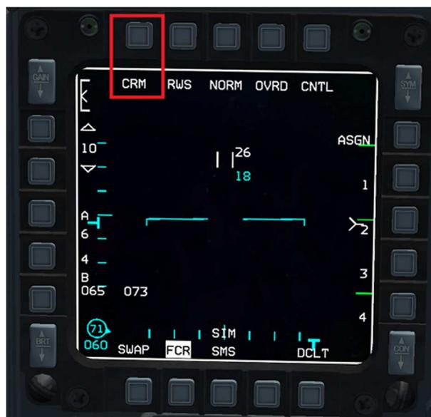
Le pilote est passé en mode air-air en appuyant sur le bouton correspondant de l'ICP. Il clique sur l'OSB 1, au-dessus de la mention CRM.
