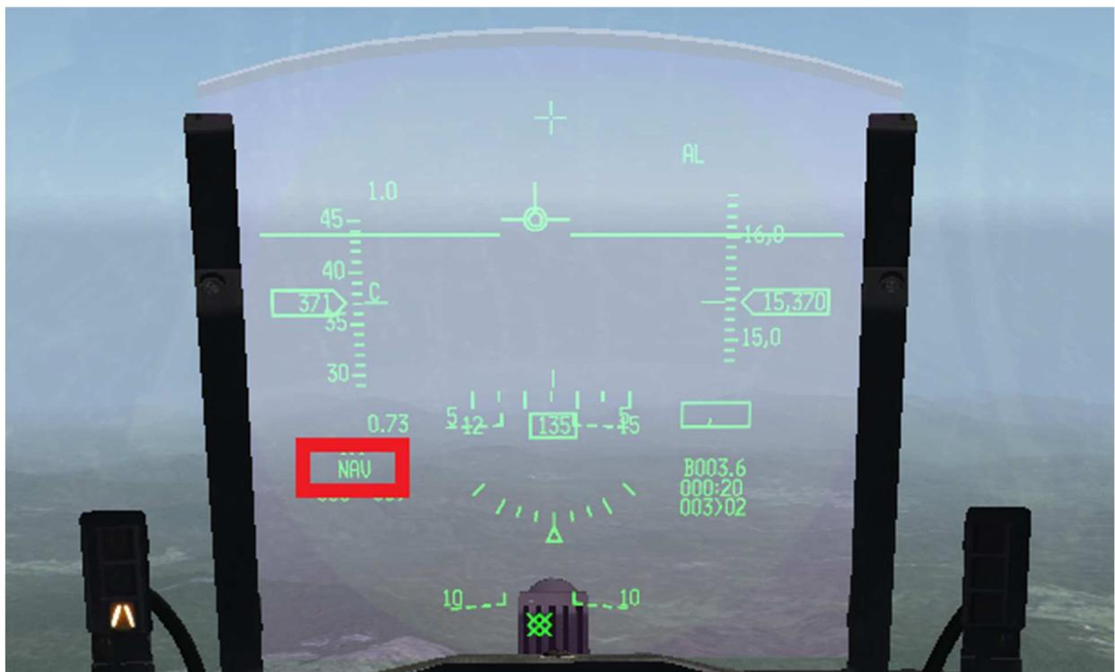
Cet emplacement particulier dans le HUD permet de vérifier dans quel mode on se trouve. Ici en mode NAV.
