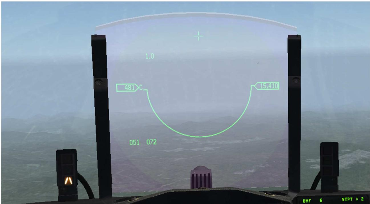
On effectue un *TMS RIGHT* pour passer en mode ACM 30x20. La mention NO RAD s'est effacée. Le radar balaie dans les limites du HUD.
