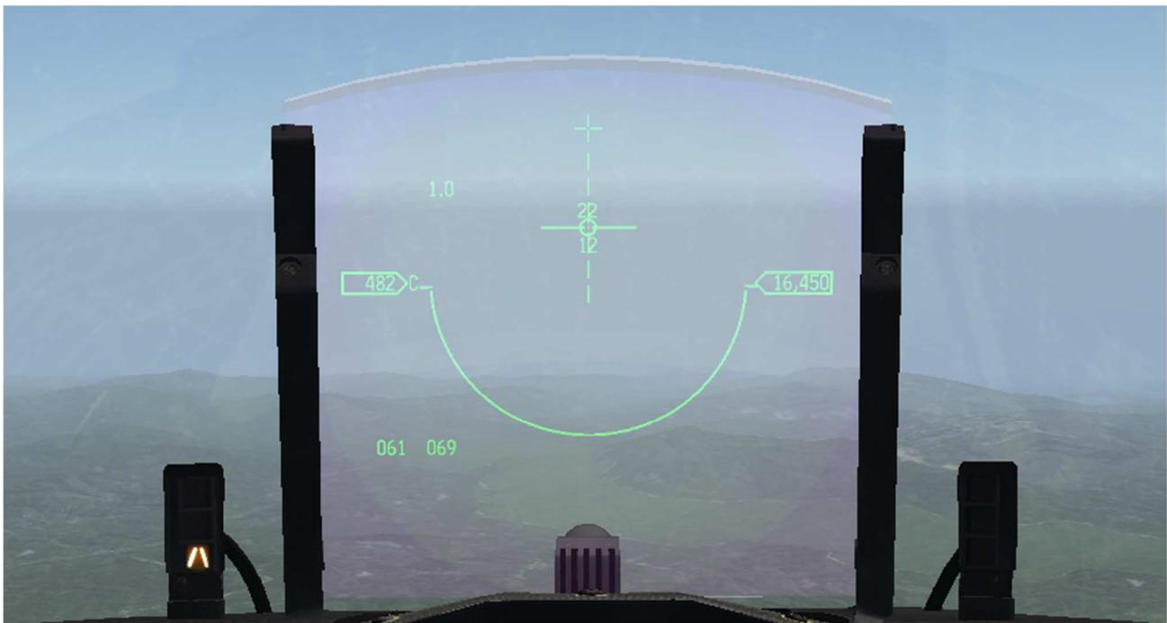
On appuie sur une commande de curseur (peu importe dans quel sens). Le radar passe en sous-mode SLEW. Une grande croix s'affiche dans le HUD, avec sur son centre un petit rond, encadré des nombres 22 et 12. Cela signifie que le cône de balayage de l'avion est dans l'axe de l'avion, et qu'à une distance de 10 NM ce cône couvre les altitudes allant de 12 000 ft à 22 000 ft.
