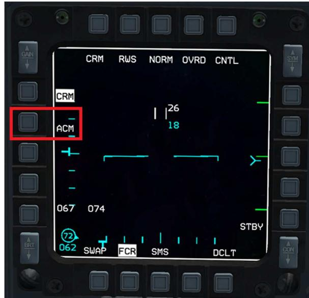
Un petit menu apparaît en haut à gauche, proposant alors de choisir entre le mode radar CRM et le mode radar ACM. Le pilote sur l'OSB 19, à côté de la mention ACM.
