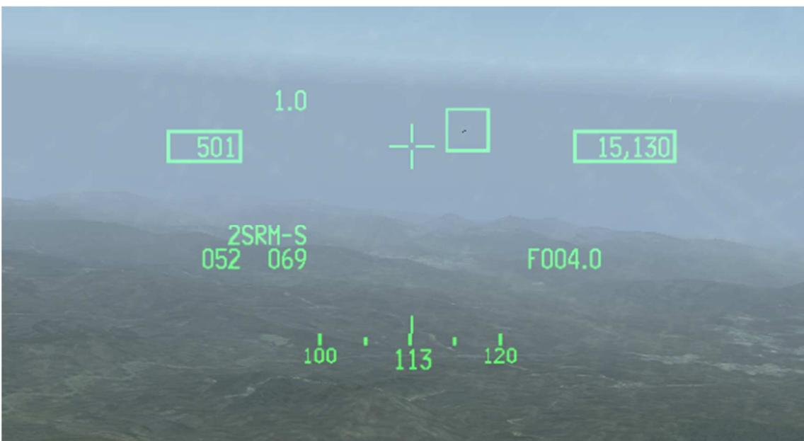
Un appareil est aperçu. On porte le regard vers lui : dès que l'appareil aperçu passe sous l'ellipse, le radar l'accroche. Un carré de désignation suit dorénavant en permanence la cible, dont la distance mesurée par le radar s'affiche en bas à droite. Ici 4,0 NM.
