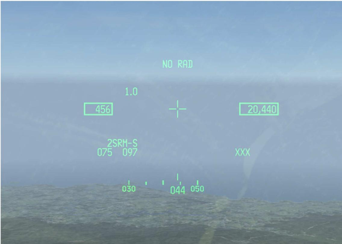
Visualisation de casque allumée, on passe en mode ACM. La mention NO RAD s'affiche en haut (le radar n'émet pas), et la mention NAV en bas à droite est remplacée par la mention 2SRM-S (qui signifie que sont sélectionnés les missiles courte portée, qu'il en reste deux et qu'ils sont asservis au radar).
