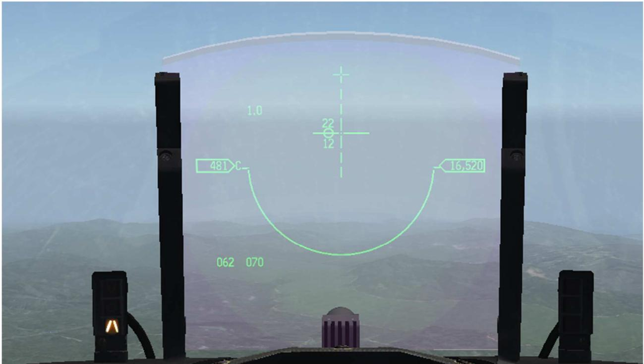
On déplace le centre du cône de balayage vers la gauche avec la commande de curseur. Le rond se déplace horizontalement, indiquant que radar est braqué à environ la moitié de son débattement possible vers la gauche, soit environ 30°.
