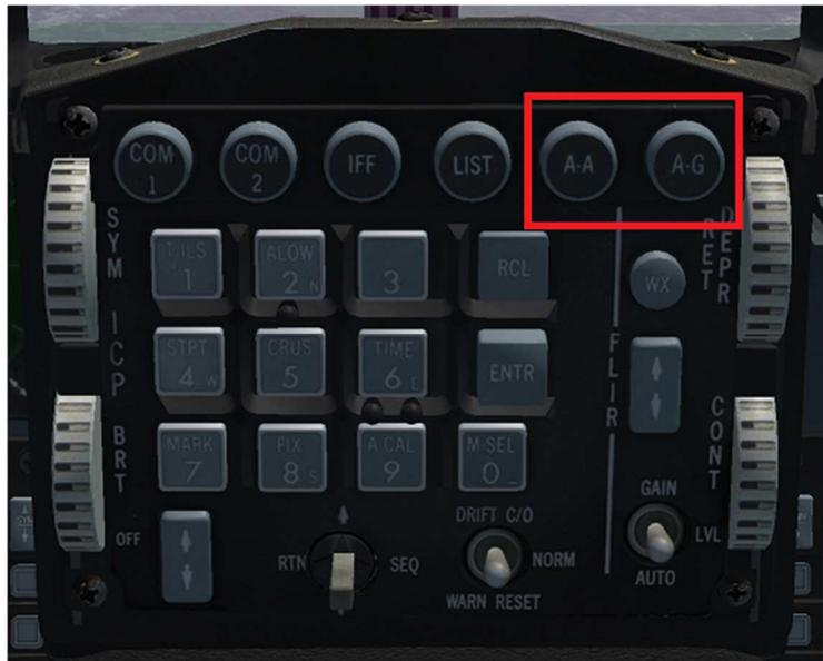
Les deux boutons de l'ICP permettant d'appeler les modes supérieurs air-air et air-sol.
