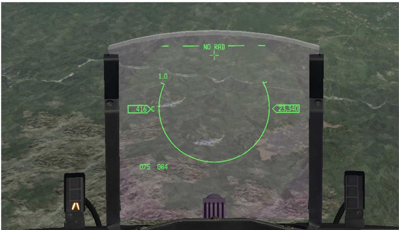
À l'inverse, si le nez est abaissé vers le sol, comme ici, l'arc s'allonge. Notez que l'on est en vol en palier lorsque l'arc s'étend sur la moitié d'un cercle, et à inclinaison nulle lorsque chacune des extrémités de l'arc est alignée avec les fenêtres de vitesse et d'altitude.
