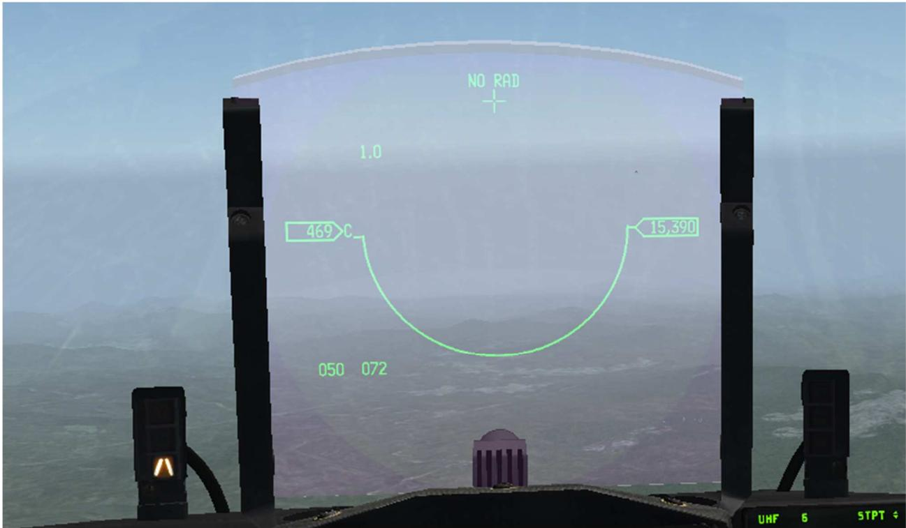
On sait que la cible se trouve en gros devant l'avion, et à moins de 10 NM, mais on ne l'a pas encore aperçue. Le radar est en mode ACM NO RAD : il n'émet pas.
